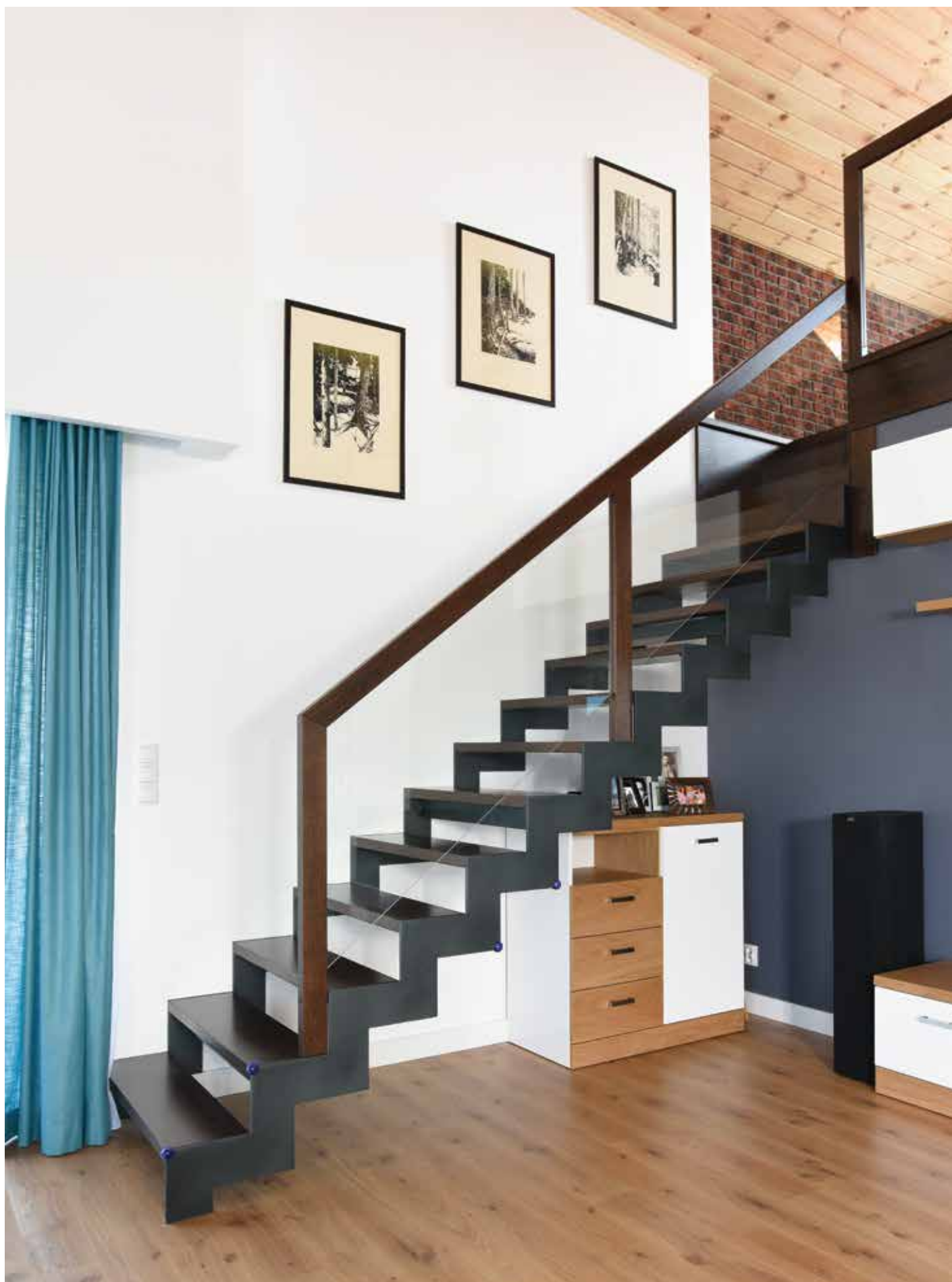
P192 Schody na konstrukcji metalowej | drewno: dąb bejcowany | balustrada: szkło + drewno Stahltruppe | Holz: gebeizte Eiche | Geländer: Glas + Holz
