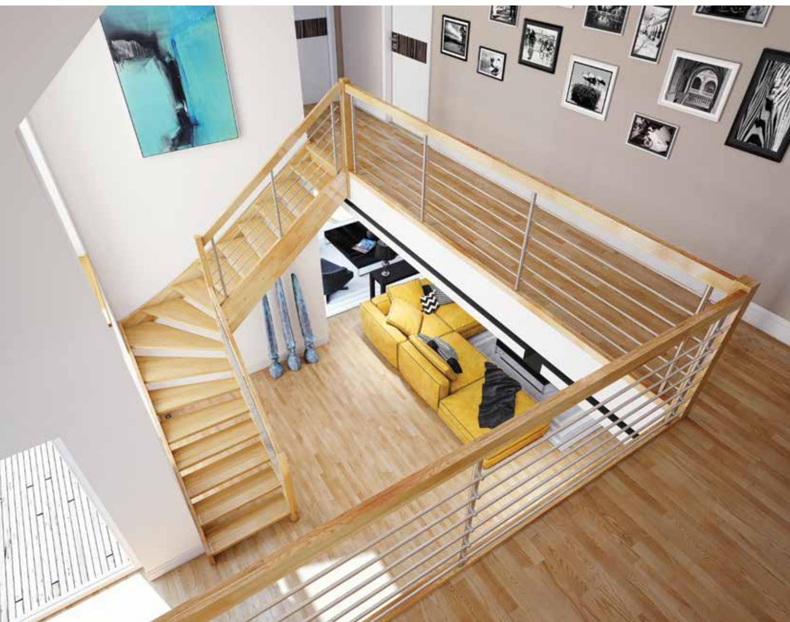
W3 Schody na konstrukcji metalowej | balustrada: stal + drewno Stahltrappe | Geländer: Stahl + Holz
