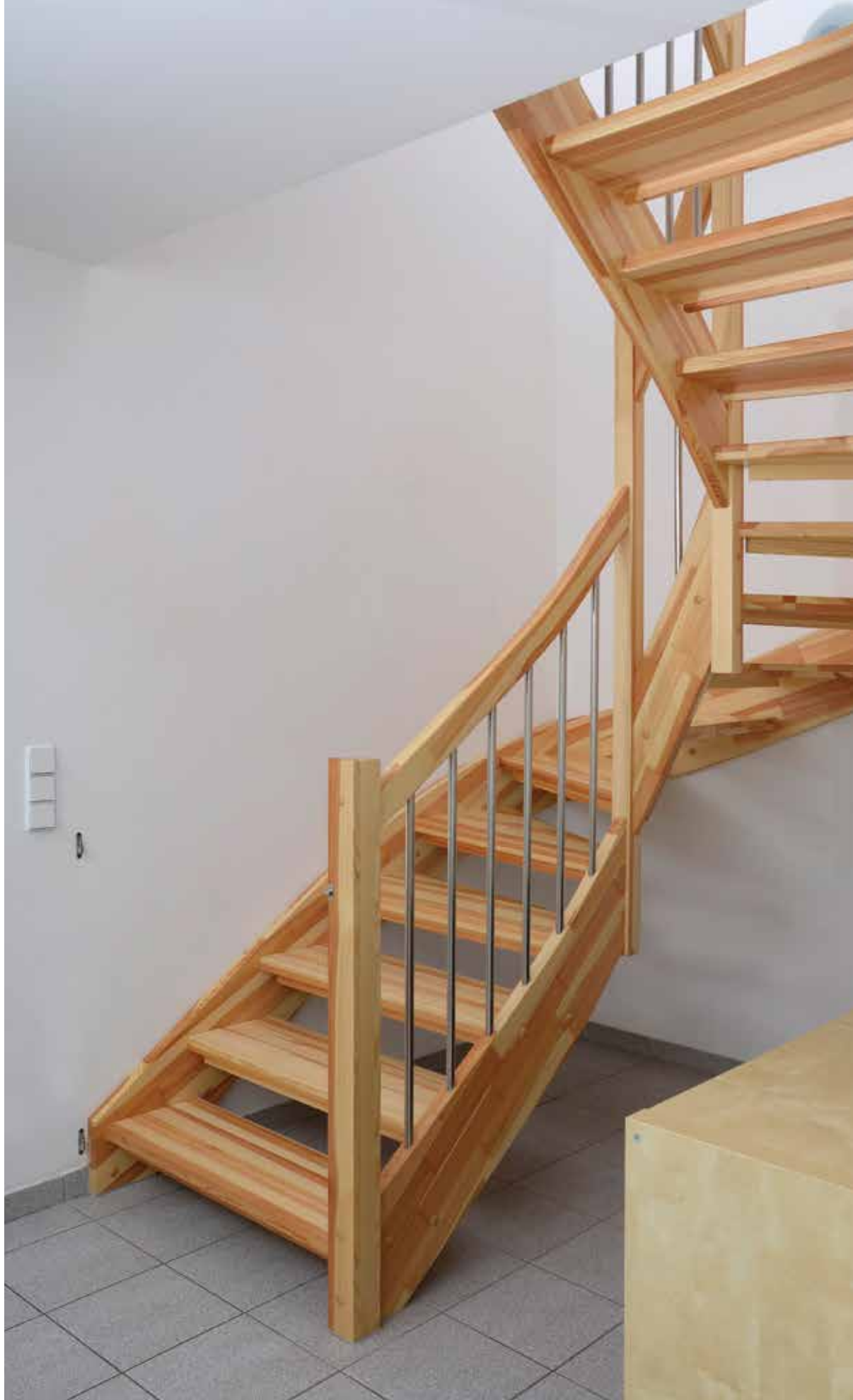
P178 Schody policzkowe | drewno: sosna | balustrada: drewniana Wagentreppe | Konstruktion: Holz | Holz: Kiefer | Geländer: Holz
